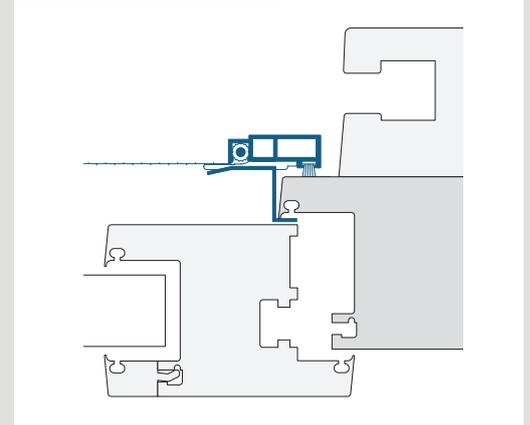
**Zusatzgriff:** Um den Spannrahmen problemlos einhängen zu können, befindet sich direkt unterhalb der oberen Seitenarretierung ein weiterer Griff.
